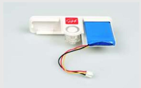
Rückseite von **CLAB** mit dem Akku im internen Batteriefach.
