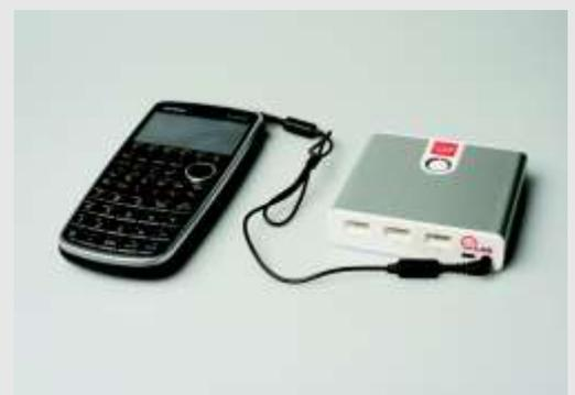
Der CASIO Grafikrechner fx-CG 20 kann mit CLAB via Datenkabel verbunden werden.
