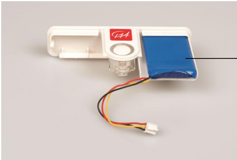
CLAB achterzijde met oplaadbare batterij in het batterij compartiment
