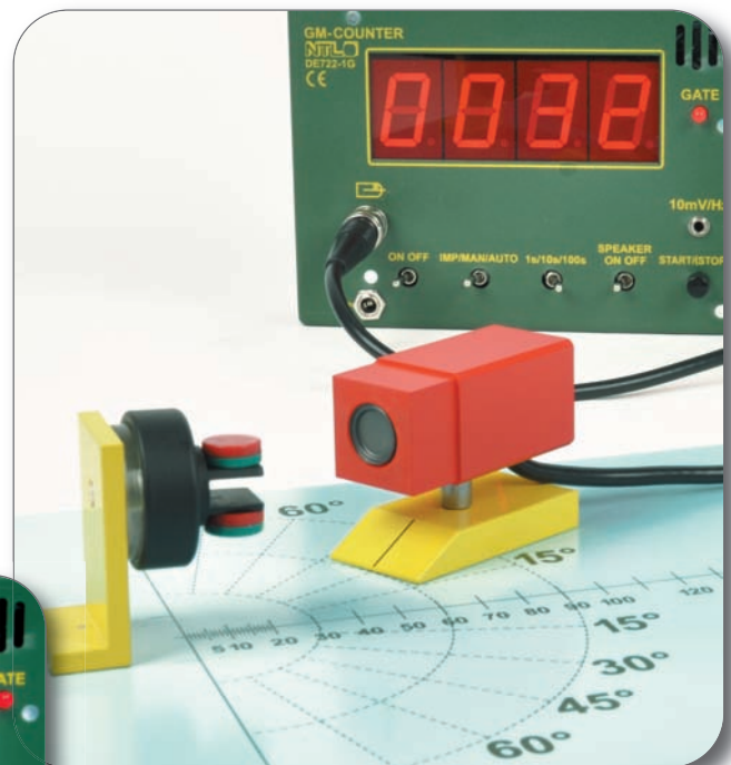
RAI 3.2 Gedrag van bètastraling in een magnetisch veld
