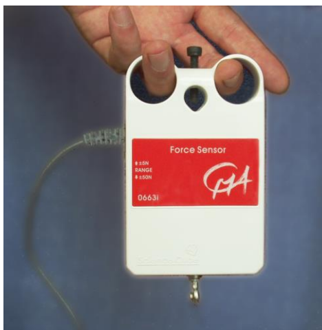
Figuur 2: Houd de krachtsensor in de hand of monteer hem aan een statief
