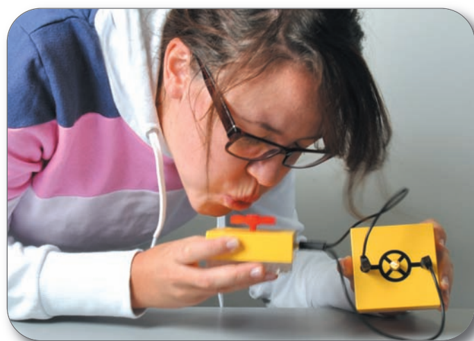
Door te blazen tegen een propeller gaat het lampje branden
