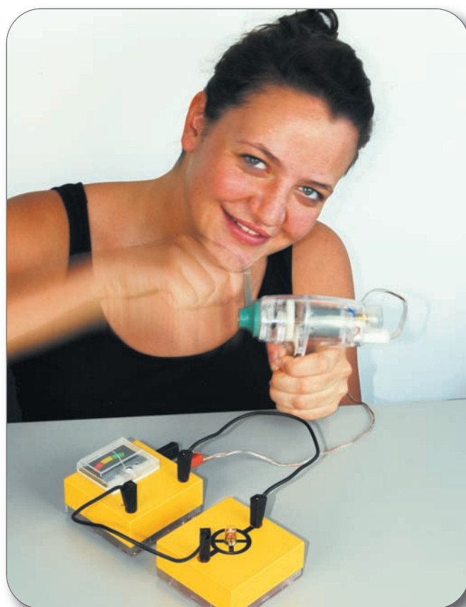
Energie-opslag in krachtige condensator met display (principe van hybride auto)
