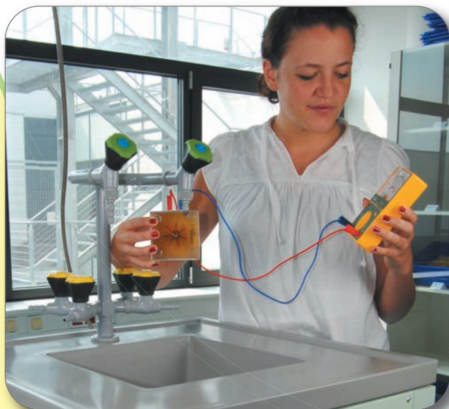
Energie van water wordt omgezet in elektrische energie
