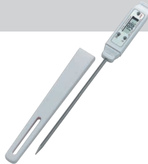
C4350-1A Leerlingthermometer, digitaal, 200 °C. Metalen sensor, L=125 mm, meetbereik van -40 °C. tot +200 °C. Nauwkeurigheid +/- 1 °C , resolutie 0,1 °C. Functies: Hold, Maximum, Minimum, batterijvoeding, schakelt na gebruik automatisch uit.
