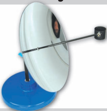
P2885-1P Parabolische spiegel op voet In het brandpunt van deze spiegel kunnen hoge temperaturen bereikt worden door de bundeling van warmtestralen; parabolische kunststof spiegel, met in het brandpunt een kleine metalen houder; grote bodemplaat met verstelbaar frame zodat de optimale invalshoek ingesteld kan worden.
